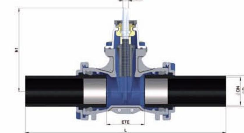
Трубные концы из PE 100 под сварку изготовлены методом литья под давлением (черные для воды и газа) с опорной втулкой из нержавеющей стали.
